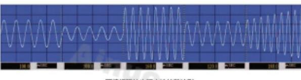
可编辑编程步源交流拉载波形
